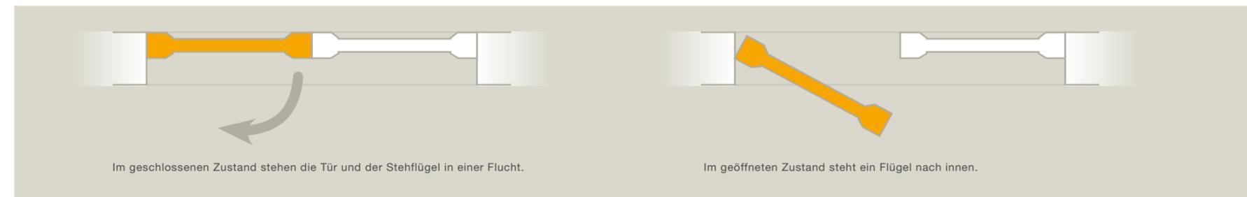
Im geschlossenen Zustand stehen die Tür und der Stehflügel in einer Flucht.
