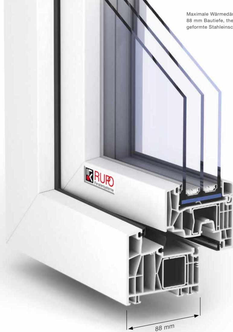
Maximale Wärmedämmung und Stabilität durch 88 mm Bautiefe, thermooptimierte 7-Kammer-Profile und speziell geformte Stahleinschübe.
